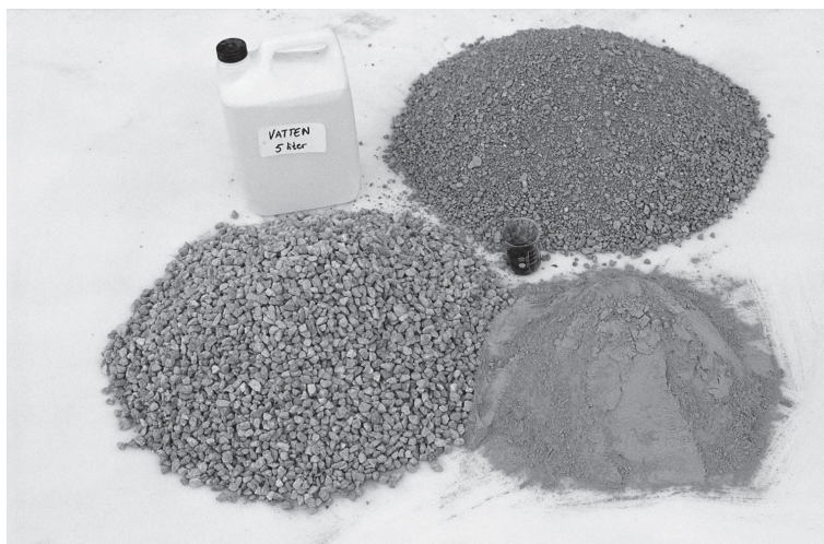
Figur 1.1:1. Sten, sand, vatten och cement utgår delmaterialen i betong. Foto: CBI Betonginstitutet AB.
